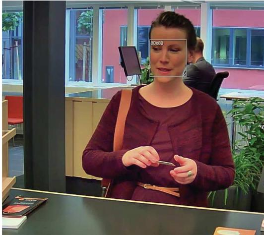
Figura 2.3c Contatore di pixel Axis che mostra la risoluzione in pixel di un volto.
