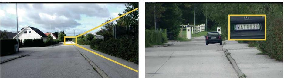
Figura 2.4q A sinistra la vista ampia e a destra la vista zoomata con telecamera PTZ HDTV 1080p che consente la lettura della targa a 275 m di distanza.
