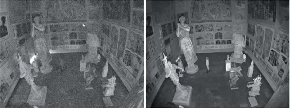
Figura 2.2b A sinistra: immagine in modalità notturna senza utilizzo degli illuminatori IR (la telecamera ha usato una piccola quantità di luce che proviene da sotto una porta nell'angolo a sinistra della stanza). Sulla destra, immagine in modalità notturna con illuminatori IR.
