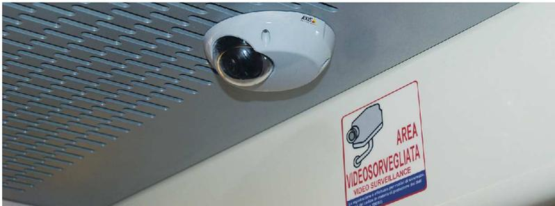
Figura 2.4d *Telecamera a cupola fissa di bordo montata sul soffitto di una carrozza ferroviaria.*
