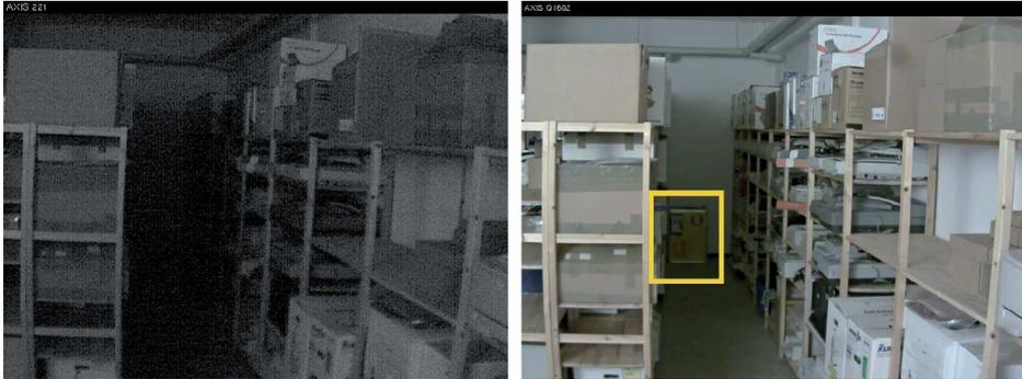
Figura 2.2c A sinistra, scena ripresa da una telecamera in modalità notturna con 0,4 lux di illuminazione sulla parete posteriore. A destra, la telecamera con tecnologia Lightfinder (ancora in modalità diurna) produce un'immagine a colori con dettagli quali la scatola sul pavimento vicino alla parete posteriore.
