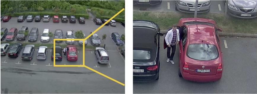
Figura 2.4h A sinistra, un'immagine panoramica in scala ridotta. Sulla destra, AXIS Digital Autotracking fornisce una visualizzazione ritagliata, senza nessuna perdita nella qualità d'immagine, dell'area dove vi è attività.
