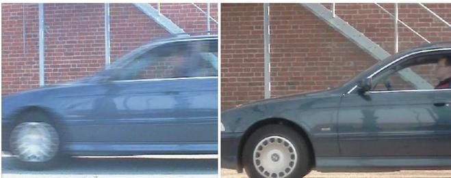
Figura 3.5b *A sinistra, un'immagine JPEG full-size (704x576 pixel) di una telecamera analogica a scansione interlacciata. A destra, un'immagine JPEG full-size (640x480 pixel) di una telecamera di rete Axis con tecnologia a scansione progressiva. Le telecamere utilizzano lo stesso tipo di obiettivo e la velocità dell'auto è identica (20 km/h). Lo sfondo è chiaro in entrambe le immagini. Tuttavia, l'autista è chiaramente visibile solo in quella a scansione progressiva.*
